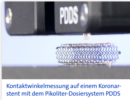
Kontaktwinkelmessung auf mikrostrukturierten Proben mit dem OCA 200 und Nanoliter- und Pikoliter-Dosiersystem PDDS
