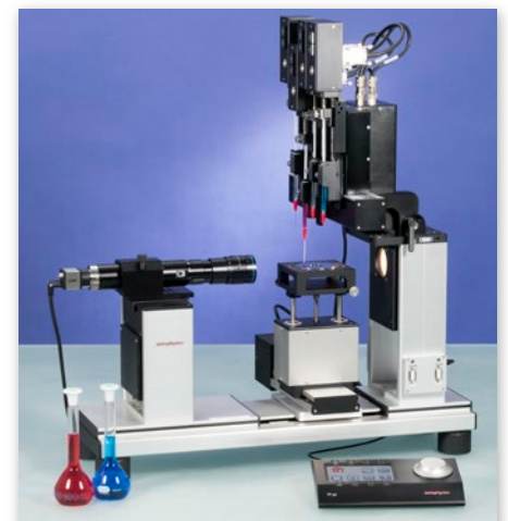
Bestimmung der Oberflächenenergie mit einem OCA 200 und DDE/4 mit vier ESr-N
