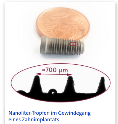
Kontaktwinkelmessung auf mikrostrukturierten Proben mit dem OCA 200 und Nanoliter- und Pikoliter-Dosiersystem PDDS
